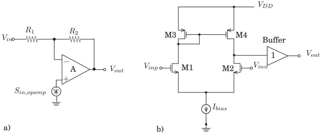
**Figure 4:** a) A noisy inverting op.amp. b) The principal schematic of the op.amp.
