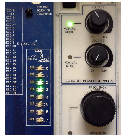
Figur 8: Styr spänningen U_{in} med ratten längst upp
