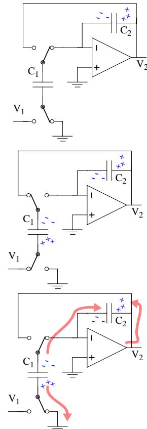
Vid tidpunkt  $t + \tau$  har switchen slagit om. Därmed kan kondensator  $C_1$  laddas upp med hjälp av  $v_1(t + \tau)$  och operationsförstärkarens utgång som skjuter till laddning. Detta ger att
