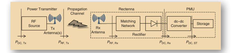
$$e = \frac{P_{\text{DC,ST}}}{P_{\text{DC,Tx}}} = \frac{P_{\text{RF,Tx}}}{\underbrace{P_{\text{DC,Tx}}}_{e_1}} \quad \frac{P_{\text{RF,Rx}}}{\underbrace{P_{\text{RF,Rx}}}_{e_2}} \quad \frac{P_{\text{DC,Rx}}}{\underbrace{P_{\text{RF,Rx}}}_{e_3}} \quad \frac{P_{\text{DC,Rx}}}{\underbrace{P_{\text{DC,Rx}}}_{e_4}}$$
