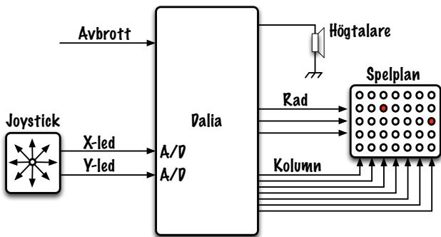
Principschema över spelets hårdvara. Joystickens läge omvandlas med inbyggd A/D-omvandlare och används av programmet för att styra den egna markören. "Målet" utgörs av en lysdiod i spelplanens vänstra halva. Vid träff skall ett ljud höras ur högtalaren.
