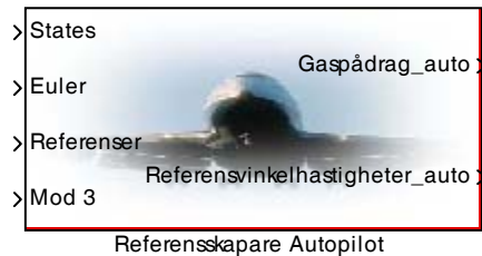
Figur 9. In- och utsignaler till referensskapare autopilot.
