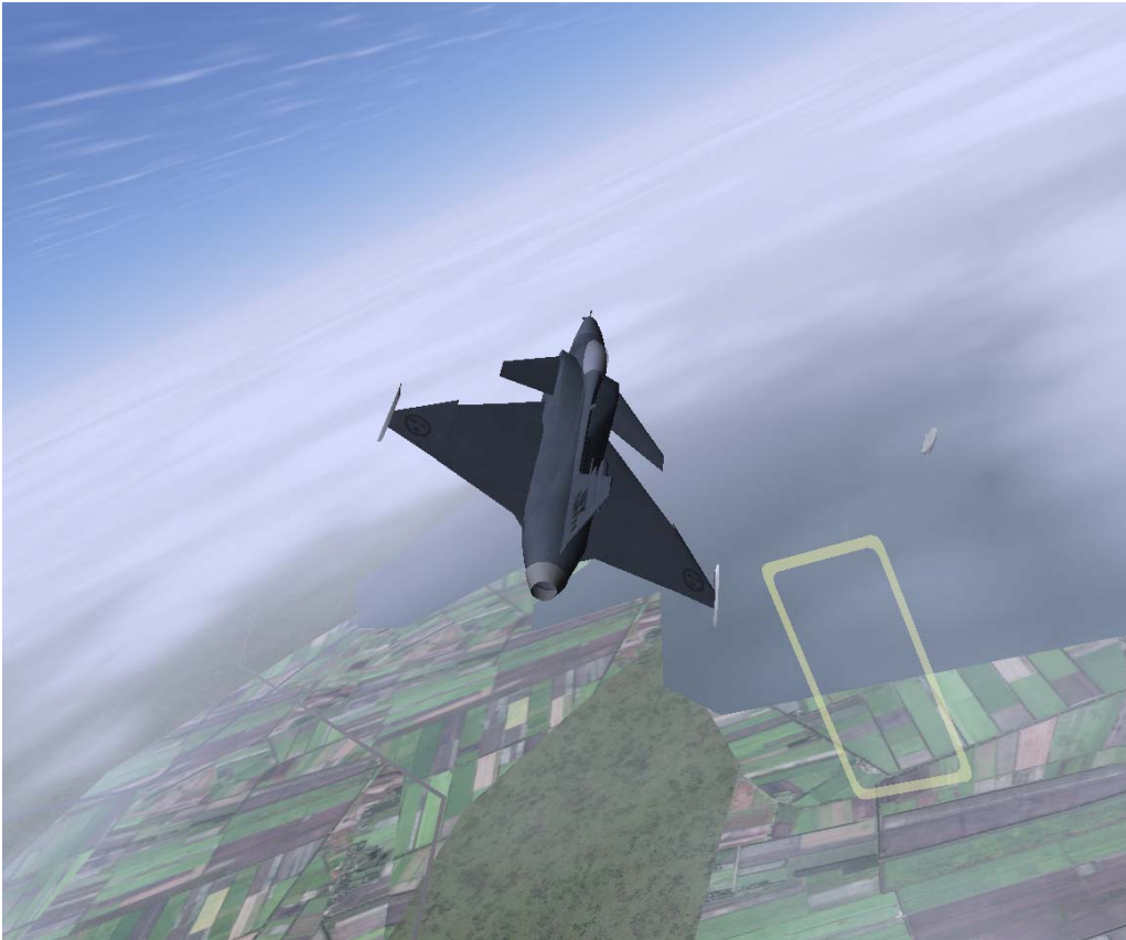
Figur 4. Kontrollblocket triggar när planet flyger genom den gula rektangeln, luftväggen.
