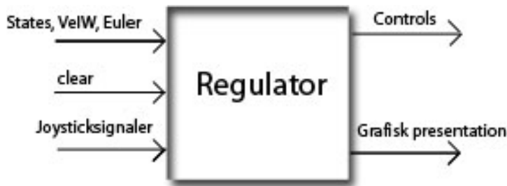
Figur 7. Regulatorns in- och utsignaler.
