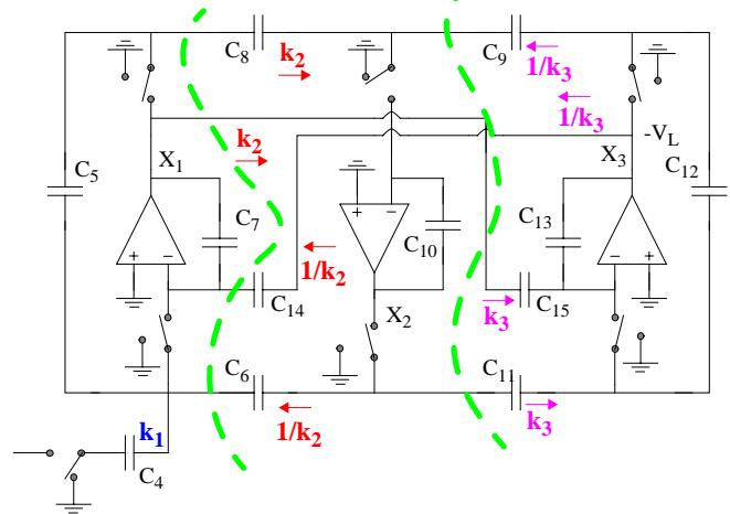
Skala filtret så att förhållandet mellan utgångarna på operationsförstärkarna och insignalen är lika med 1. (Om insignalen tillåts pendla mellan maximalt och minimalt tillåtet värde.) Orsaken till skalningen är att hålla nere utsignalnivån på operationsförstärkarna så att dessa inte överstyrts inne i filtret.
