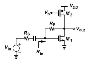
a) Determine the input impedance  $(R_{in})$  of the LNA. (1 p)
